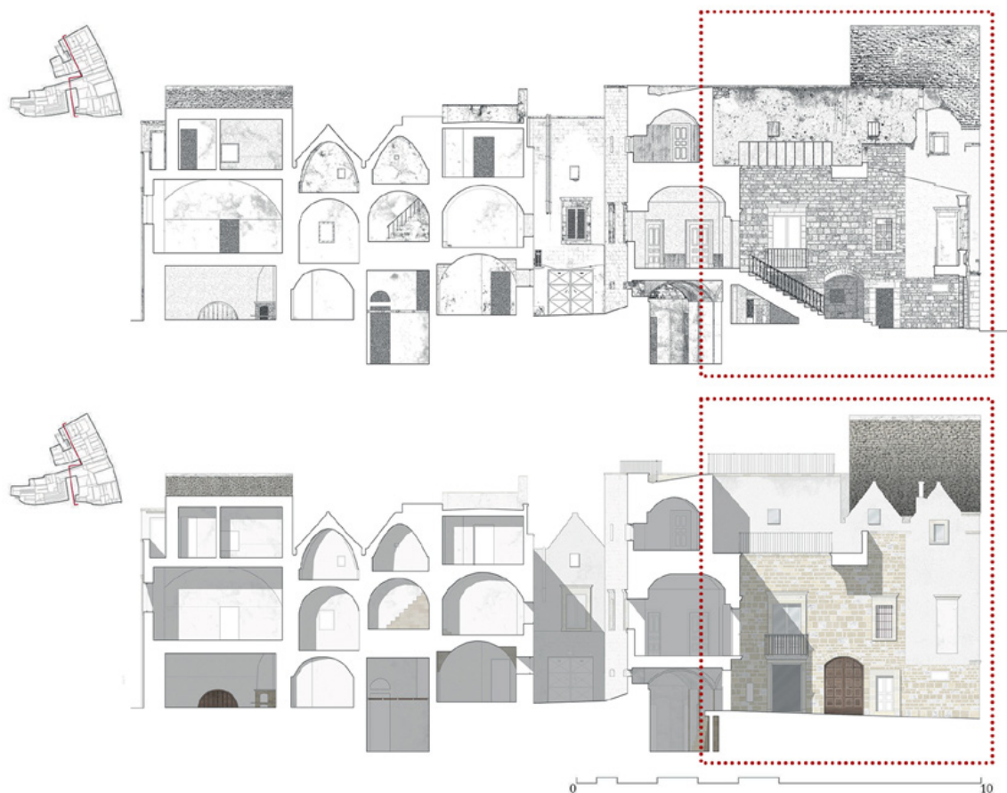
Figure 2. Rilievo e prefigurazione del progetto di restauro dell'isolato n. 3, sezione trasversale. Restituzione grafica di Caterina Anelli, Giorgio Bevilacqua, Annalisa Cascione, Serena Cellie, Roberta Quaranta, Antonio De Liddo, 2015.
